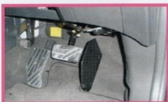
手動運転装置をご利用の方にアクセルペダルの跳ね上げと共に、右足でブレーキペダルを踏まないように防止する板を作りました。(特注品)
