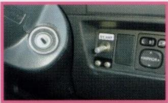
キーをひねってエンジンをかける動作が難しい方に。キーをONまで回した後、スイッチを押すとエンジンがかかります。
